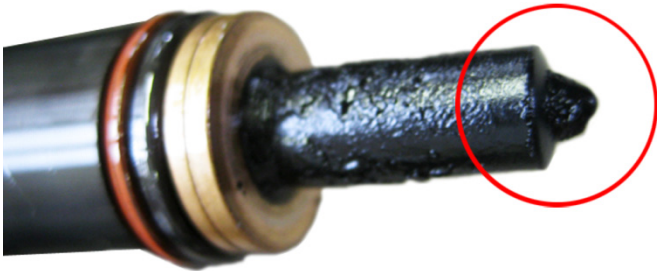
Slika 3: Element raspršivača pumpe zapekao
