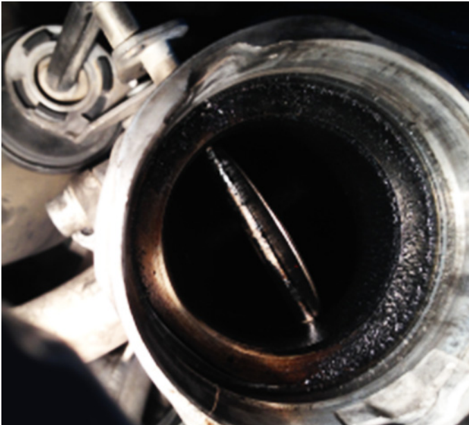
Slika 4: Klapna ventila za recirkulaciju izduvnih gasova (EGR ventil) zapekao
