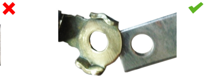
Slika 2: Spoj na masu nakon čišćenja: dobar kontakt
